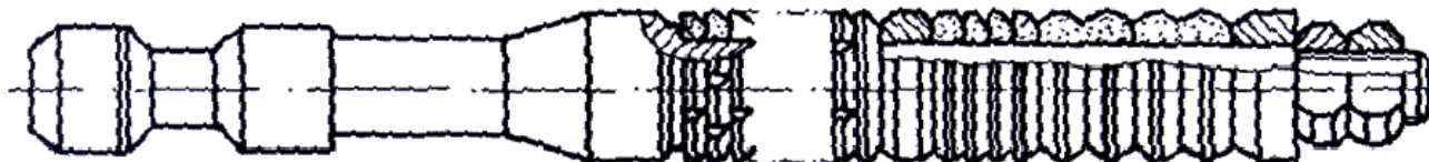
Фиг. 8.12. Протяжка с механично закрепени зъби от металокерамика
