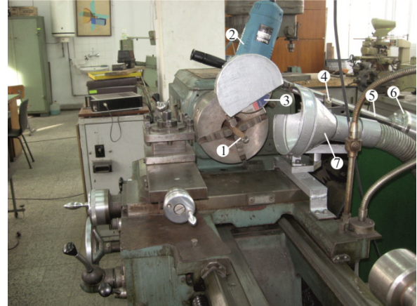
Фиг. 1. Приспособление за еластично абразивно отрязване: 1 – обработвана заготовка; 2 – ъглошлифовъчна машина; 3 – отрезен диск; 4 – ос за лагеруване; 5 – рамо; 6 – противотежест; 7 – аспирационна уредба
